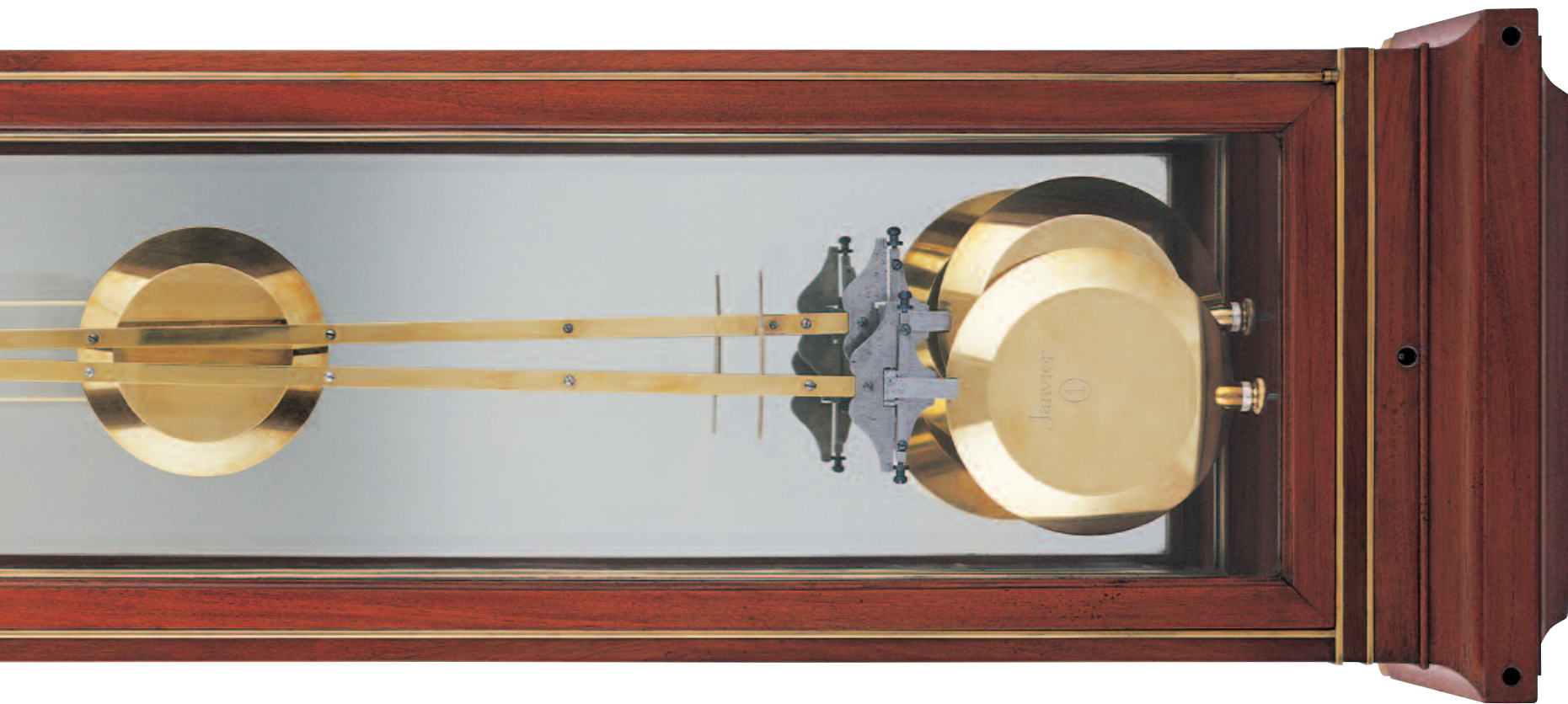
Régulateur à résonance de l'horloger français Antide Janvier réalisé vers 1780. Il a inspiré les recherches de François-Paul Journe sur ce phénomène, pour aboutir à la création du premier chronomètre à résonance en montre-bracelet, deuxième modèle de la collection F.P.Journe – Invenit et Fecit –. Collection Montres Journe SA - Genève
